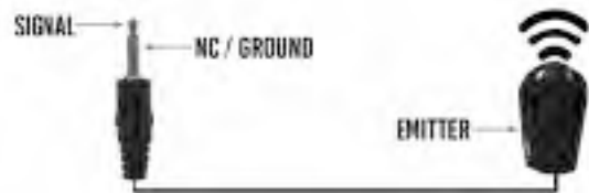
IR OUTPUT (IR Emitter)
