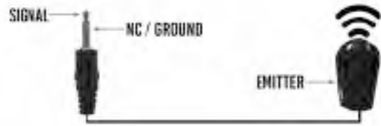
IR OUTPUT (IR Emitter)
