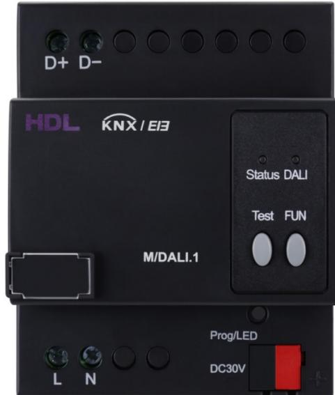
Con l'alimentatore DALI integrato e un singolo bus DALI, il gateway KNX-DALI può essere collegato a un massimo di 64 dispositivi DALI. Il rilevamento dei guasti in tempo reale consente al gateway di rilevare i guasti dei reattori e delle lampade, ecc.
