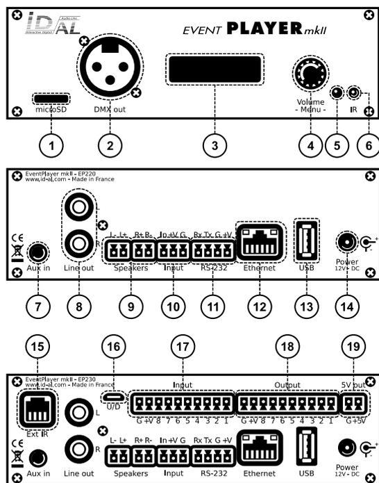
La gamme EventPlayer mkII est composée de lecteurs show control et audio autonomes gérant la lecture de fichiers WAV / MP3 / SC2 stockés sur une carte microSD ou sur une clé USB. Les fichiers peuvent être lus automatiquement à la mise sous tension, par programmation horodatée ou sur déclenchement par des événements externes (contacts d'entrée, commandes RS-232 ou web, télécommande infrarouge).
